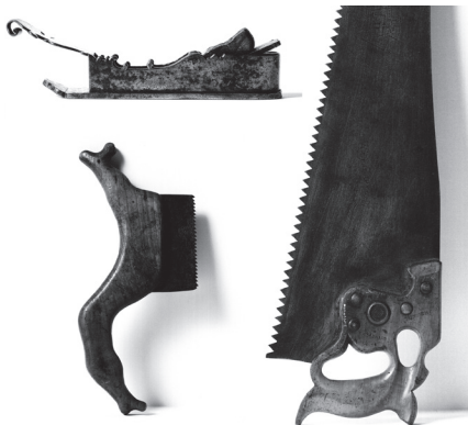
図8 左上:17世紀フランスの台カンナ / 左下:19世紀スイスの溝挽ノコギリ / 右:19世紀イギリスのノコギリ(写真:齊藤保憲, ヨーロッパの伝統木工具, p.81,87,97)
