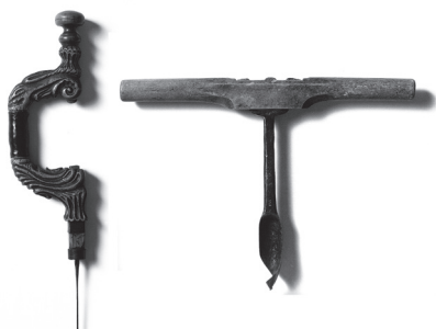
図9 左:18世紀オーストリアのハンドルキリ / 右:18世紀スイスのポートキリ(写真:齊藤保憲, ヨーロッパの伝統木工具, p.115,119)
